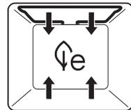
Questo modo di funzionamento consente un notevole risparmio di energia. Il riscaldamento avviene mediante l'elemento riscaldante superiore e inferiore. L'umidità propria generata dagli alimenti viene mantenuta all'interno della camera di cottura. L'alimento si secca meno.
