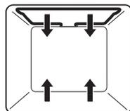
Il riscaldamento avviene mediante l'elemento riscaldante superiore e inferiore.
