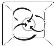
L'aria della camera di cottura viene riscaldata dall'apposito elemento dietro la parete posteriore e circola in modo uniforme.
