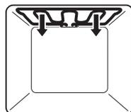
Il riscaldamento avviene mediante l'elemento riscaldante del grill.
