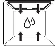
Il riscaldamento avviene mediante l'elemento riscaldante superiore e inferiore. L'umidità propria generata dagli alimenti viene mantenuta all'interno della camera di cottura. L'alimento si secca meno.
